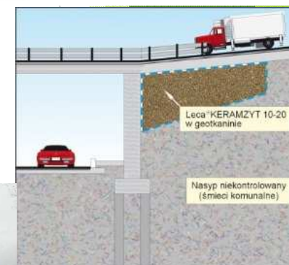
Uzyskano odciążenie organicznego podłoża oraz zlikwidowano parcie poziome na przyczółek dzięki warstwie 900 m 3 keramzytu ułożonego w nasypie drogowym - Wolsztyn 2007
